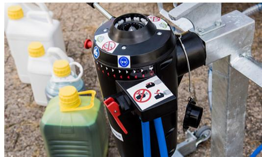
Ce système est constitué de deux éléments : un bouchon à vis pré-monté sur les bidons et un connecteur autonome pouvant être fixé un trépied ou bien sur le pulvérisateur en lui-même.
