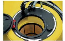
Pour certains pulvérisateurs où le produit passe du bac incorporateur par le « trou d'homme » avant d'arriver dans la cuve : si l'accessibilité le permet et s'il n'y a pas de risque d'éclaboussure avec l'agitation, privilégier la mise en œuvre du produit en formulation WG via le « trou d'homme ».
